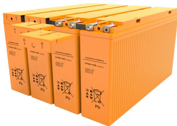
6-FMXH高温型阀控密封铅酸蓄电池是唐泰集团针对高温使用环境自主研发的新型产品，把铅酸电池的工作温度从25°C提高到35°C，并保持了同样的寿命水平。外部连接采用前端子设计，装卸简便；狭长型结构，电池长宽比例达 3.75 ~ 5.00，增强散热性能，有效减少热失控情况发生。
